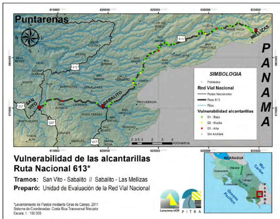
Figura 2. Vulnerabilidad de las alcantarillas en el Tramo analizado de la Ruta Nacional N°613 Fuente: LanammeUCR, 2011.
