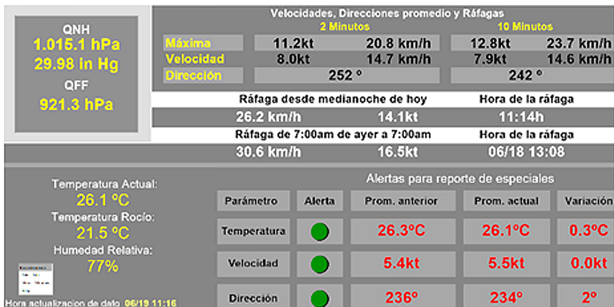
Figura 1. Visualización de una estación meteorológica automática (EMA) y sus respectivas variables meteorológicas desplegadas en los servicios de tránsito aéreo (ATC, siglas en inglés).
